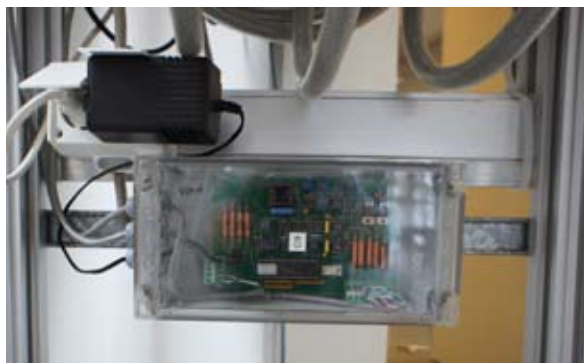
Styreskap med PLS og releer. Her bearbejdes alle innkommende data fra måleenhetene. Signalene definerer kjettingtaljen og løpekattens bevegelse og posisjoner.
